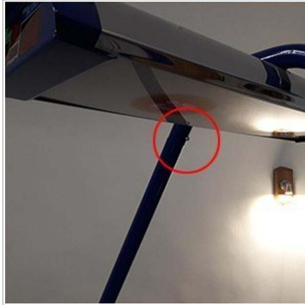
7. || Führen Sie die Kabel durch die Öffnung, verbinden und montieren Sie die Trennwand und die Lampe ||
